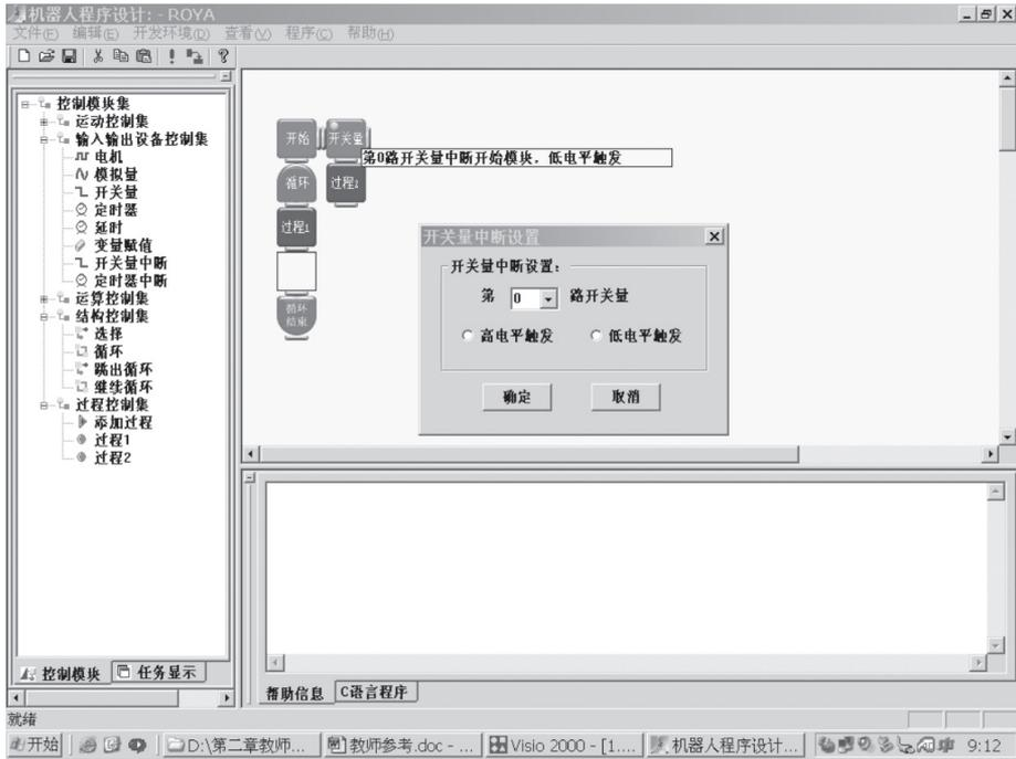
图 2.7 “开关量中断”模块属性设置
