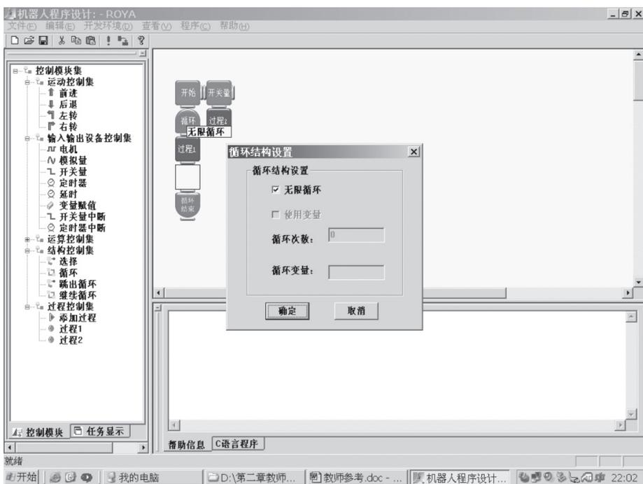
图 2.6 “循环”模块属性设置界面
