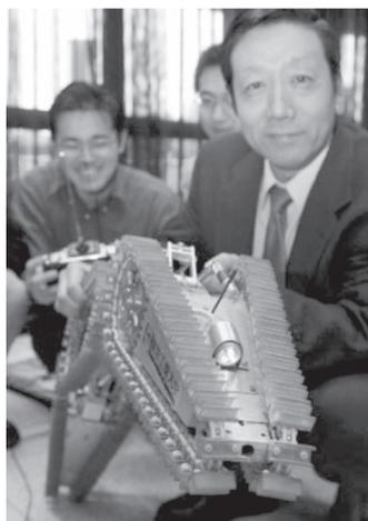
图 1.8 可变形履带式地震救援机器人
