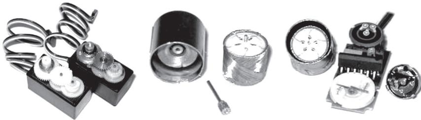
图 3.17 舵机的内部构造
