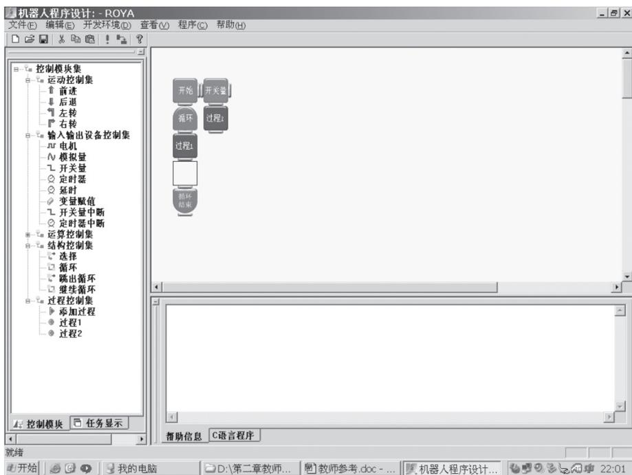
图 2.5 实验 3 程序中使用“开关量中断”模块
