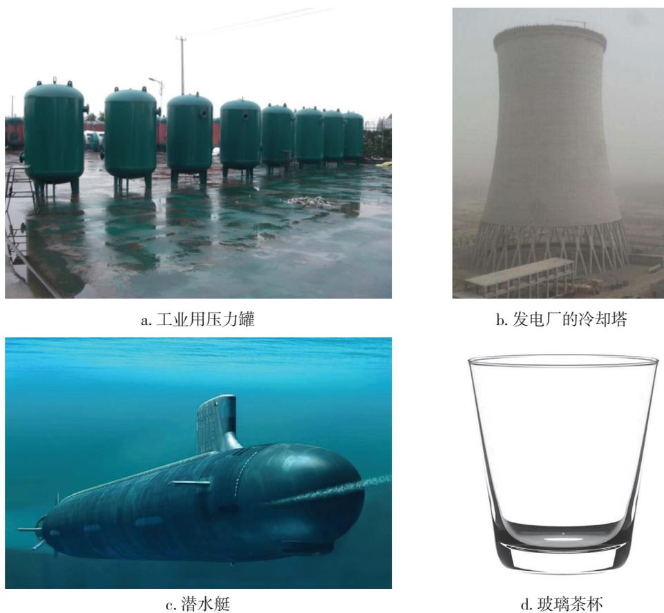
图 1.5 几种典型的薄壳结构
