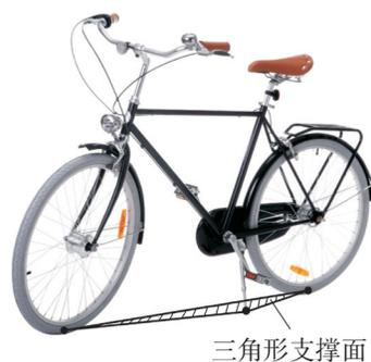
图 1.27 自行车的支撑面
