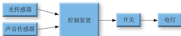
图 4.5 楼道电灯的自动控制
